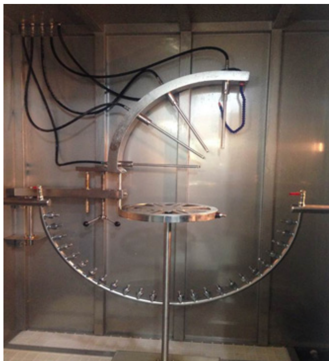
圖 8 IPX9K 防水實驗設備
