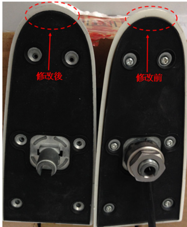
圖14 修改前、後的鰭式天線防水墊圈尺寸圖
