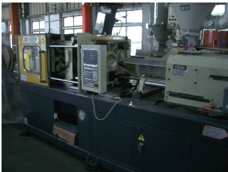
圖4 震雄機械50T SM系列曲肘式塑膠射出成型機
