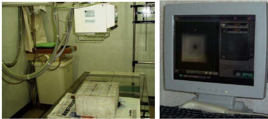
圖 3b：本試驗所使用 TOSHIBA, unit model DRX-1603B, Focal spot: 2.0/1.0 mm 之 X 光機，主要設備為 X 光管、控制台、電腦及底片傳輸裝置等
