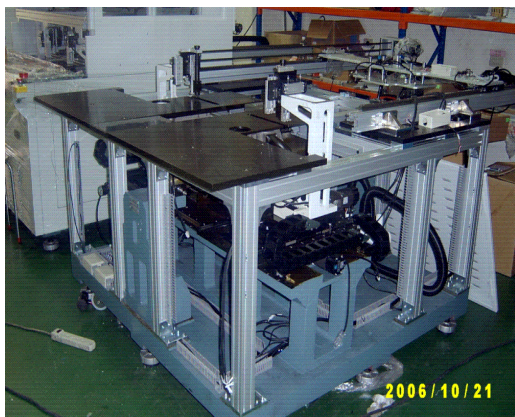
圖 3.7 實際鑽靶機組裝架構圖
