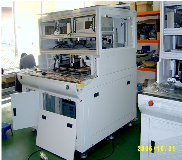
圖 2.11 改良式鑽靶機與實體對照圖
