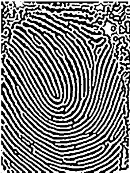
圖 3.18 經過中值濾波、平滑、強化處理後之二值化結果(300 pixel×400 pixel)
