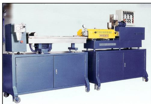
圖 1 雙螺桿押出機
