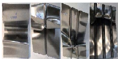
(a) CCP03 (b) CCP06 (c) CCP09 (d) CCP12 圖三. 實驗後試片照片前視圖.
